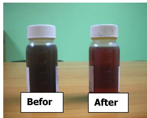
รูปที่ 2. ภาพเปรียบเทียบน้ำมันก่อนฟอกและหลังฟอก
