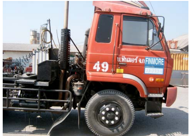
ภาพรถที่ติดตั้งเครื่องฟอกฯ Puradyn
