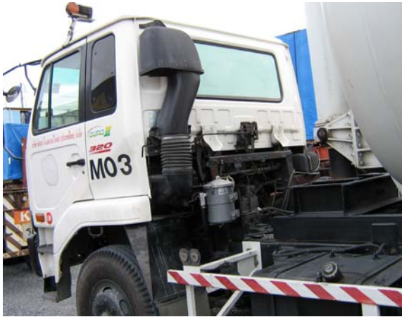
ภาพรถที่ติดตั้งเครื่องฟอกฯ Puradyn
